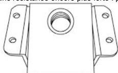
Position contre la paroi supérieure (résistance d'environ 14 kg)
