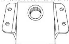
Posición contra la pared superior (resistencia de aprox. 14 kg)
