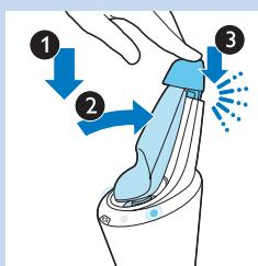
**3** Plasați aparatul de bărbierit în suport (1), înclinați aparatul de bărbierit înapoi (2) și apăsați capacul superior pentru a conecta aparatul de bărbierit (se fixează cu un „clic”) (3).
