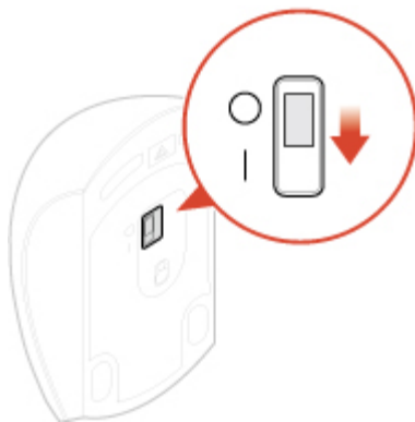
Rysunek 18. Ustawianie wyłącznika zasilania w pozycji włączonej
