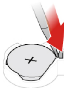
Rysunek 122. Naciskanie metalowego zaczepu śrubokrętem
