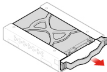
Rysunek 42. Wyjmowanie wspornika dodatkowego dysku 2,5 cala
