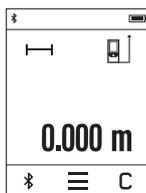
Pärast sisselülitamist on mõõteseade pikkuse mõõtmise režiimil. Teisi mõõtefunktsioone saate välja reguleerida vajutamisega nupule **k** (vt „Mõõterežiimid“, lk 259). Pärast sisselülitamist on mõõtmise lähtetasandiks mõõteseadme tagaserv. Nupule **e** vajutamisega saate lähtetasandit muuta (vt „Lähtetasandi valik“, lk 258).
