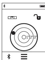
A digitális vízmérték egy tárgy (például mosógép, hűtőszekrény stb.) két tengely mentén egyidejűleg történő vízszintes irányú beállítására szolgál.
