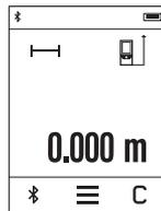
A mérőműszer a bekapcsolás után a hossz mérési funkcióban van. Más mérési funkciók beállításához meg kell nyomni a **k** gombot (lásd „Mérési funkciók”, a 70. oldalon).
