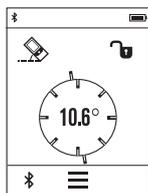
Măsurarea înclinării servește la măsurarea unei pante sau înclinări (de exemplu a scăriilor, balustradelor, potrivirea pieselor de mobilier, la montarea țevilor, ș. a. m. d.).
