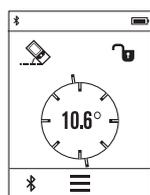
Mjerenje nagiba služi za mjerenje nagiba (npr. stepenica, ruko-hvata, kod montaže namještaja, kod polaganja cijevi itd.).
