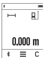
Po włączeniu urządzenie automatycznie ustawia się w funkcji pomiar długości. Pozostałe funkcje pomiarowe można wybrać za pomocą przycisków **k** (zob. »Funkcje pomiaru«, str. 15). Po włączeniu automatycznie ustawiana jest tylna krawędź urządzenia pomiarowego jako płaszczyzna referencyjna (odniesienia). Zmiany płaszczyzny referencyjne można dokonać za pomocą przycisków **e** (zob. »Wybór płaszczyzny odniesienia«, str. 14).
