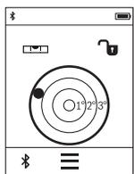
Дигиталната васер-вага служи за проверка на хоризонталното израмнување истовремено на две оски на еден објект (на пр. машина за перење, фрижидер итн.).
