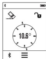
Meranie sklonu slúži na meranie stúpania alebo sklonu (napr. schodov, zábradlia, pri prispôbení nábytku, pri pokladaní rúr atď.).
