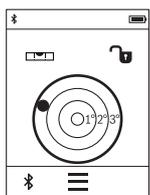
Цифровой ватерпас служит для проверки горизонтальности положения объекта по двум осям одновременно (напр., стиральной машины, холодильника и т. д.).
