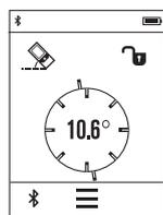
A lejtésmérés (például lépcsők, korlátok, egymáshoz illesztendő bútorok, csövek lefektetések stb.) egy menetemelkedés vagy lejtés mérésére szolgál.
