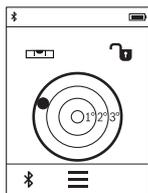
Digitalna tehtnica se uporablja za preverjanje istočasne vodoravne poravnosti objekta na dve osi (npr. pralnega stroja, hladilnika itd.).
