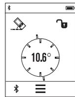
Режим вимірювання кута нахилу слугує для визначення підйому або нахилу (напр., сходових хіднів, поручнів, при підгонці меблів, при прокладанні труб тощо).
