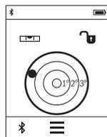
Digitálna vodováha slúži na kontrolu horizontálneho alebo vertikálneho centrovania objektu na dvoch osiach súčasne (napr. práčky, chladničky atď.).
