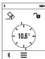
Kalde mõõtmine on ette nähtud tõusu või kalde mõõtmiseks (nt treppide, käsipuude puhul, mööbli sobitamisel, torude paigaldamisel jm).
