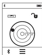
Digitalna libela služi za provjeru horizontalnog niveliranja nekog predmeta na dvije osi istodobno (npr. perilice rublja, hladnjaka itd.).
