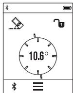
Измерването на наклон служи за измерване на ъгъл на наклонени повърхности или мислени прави (напр. на стълби, парпети, сводове за мебели, при прекарване на тръби и др. п.). Като отправна равнина при измерването на наклон служи лявата страна на измервателния уред. Ако на дисплея не се показва символа за наклон, по време на измерването уредът е бил наклонен странично твърде много.
