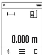
След включване измервателният уред се намира в режим за измерване на дължини. Можете да включите други режими на измерване чрез натискане на бутона **k** (вижте „Режими на измерване“, страница 169).
