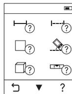
У вимірювальному інструменті для кожного режиму вимірювання є допомога у вигляді анімації. Спочатку натисніть на кнопку **h**, а потім на бажаний режим вимірювання. Анімація демонструє докладний порядок дій для обраного режиму вимірювання. Анімацію можна в будь-яку мить зупинити і розпочати знову. Її можна прокручувати вперед і назад.
