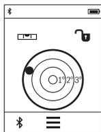
Digitalna libela služi za proveru horizontalnog poravnanja objekta (npr. mašina za pranje veša, frižider itd.) istovremeno u dve ose. Kao referentna ravan za digitalnu libelu služi zadnja strana mernog alata.
