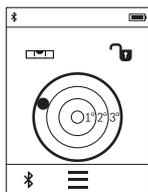
Digitaalne vesilood on ette nähtud eseme horisontaalseks nivelleerimiseks üheaegselt kahel teljel (nt pesumasin, külmkapp jmt). Digitaalse vesiloodi lähtetasandiks on mõõteseadme tagakülg.
