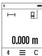
После включения измерительный инструмент находится в режиме измерения длины. Другие режимы измерения можно настроить нажатием на кнопку **k** (см. «Режимы измерений», стр. 90).
