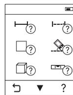
В измерительном инструменте для каждого режима измерения имеется помощь в виде анимации. Сначала нажмите кнопку **k**, а затем желаемый режим измерения. Анимация показывает подробный способ действия для выбранного режима измерения.
