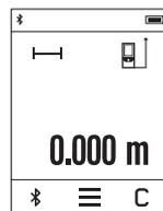
Після увімкнення вимірювальний інструмент знаходиться в режимі вимірювання довжини. Інші режими вимірювання можна налаштувати натисканням на кнопку **k** (див. «Вимірювальні функції», стор. 111).
