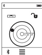
Цифровата либела служи за проверка на хоризонталното подравняване на обект едновременно спрямо две оси (напр. пералня, хладилник и др. п.).
