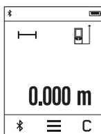
По вклучувањето, мерниот уред се наоѓа во функција на должинско мерење. Другите мерни функции може да ги поставите со притискање на копчето **k** (види „Мерни функции“, страна 188).
