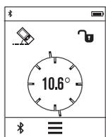
Мерењето на косини служи за мерење на нагорници и надолници (на пр. на скали, гелендери, при вклопување на мебел, при положување на цевки итн.).
