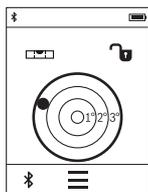
Bolobocul digital servește la verificarea alinierii simultane pe două axe ale unui obiect (de exemplu mașină de spălat, frigider ș. a. m. d.).
