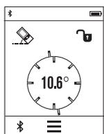
Měření sklonů slouží k měření stoupání nebo klesání (např. schodišť, zábradlí, při přizpůsobování nábytku, při pokládání trubek atd.).
