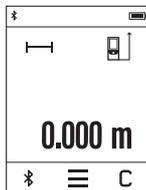
Pēc ieslēgšanas mērinstrumentu uzsāk darboties garuma mērīšanas režīmā. Pāriet uz citiem mērīšanas režīmiem var, nospiežot taustiņu **k** (skatīt sadaļu „Mērīšanas veidi” lappusē 277).
